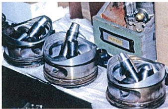
Øverst til venstre: Alt nytt – grunnoverhalt Lycoming med alt nytt tilbehør. Øverst til høyre: Ikke hele sannheten: En kompresjonstest avslører bare deler av den informasjon man trenger for å finne ut av hvordan motorens tilstand er. Over: Delesamling: På stemplene ser man tydelig ringene som er i kontakt med sylinderveggene
